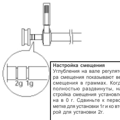
Возвратите тонарм на его подставку, и теперь можно установить прижимную силу звукоснимателя, устанавливая регулятор прижимной силы в верхний предел диапазона для головки звукоснимателя, рекомендуемый изготовителем, обращая внимание на знак на тонарме. Установите ползунок настройки смещения на такую же цифру, что и регулятор прижимной силы звукоснимателя т.е. прижимная сила звукоснимателя для головок звукоснимателя Rega 1.75g = 1.75g на ползунке напряжения смещения (см. слева).
